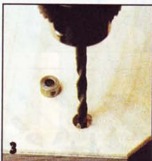
По точкам, оставшимся от острия сверла по дереву при выборке гнезда, сверлят отверстия под тросик.
