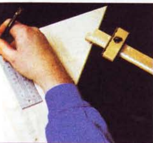
Сначала на всех полках размечают точки сверления отверстий для тросов.
