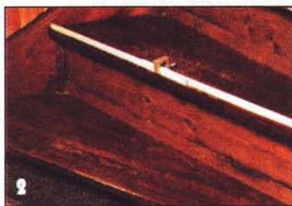
...или пары сдвижных реек. Заостренные концы реек позволяют измерить и диагонали.
