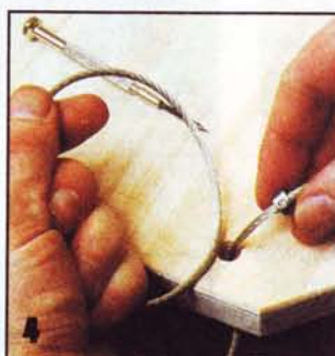
На тросик «нанизывают» установочные кольца и полки.
