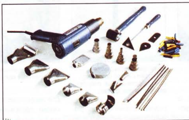
Строительный фен и его комплектующие устройства. Насадки различных исполнений, припой, прикатывающий ролик, гладилка со сменными лезвиями, термоусаживающиеся трубки.
